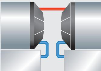
管路外露，散熱快。彎管構造循環不良，易結水垢。
